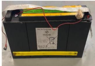
Batterie Zinc-Air → Utilisation dans les clôtures et Signalisation sur les voies des chemins de fer
